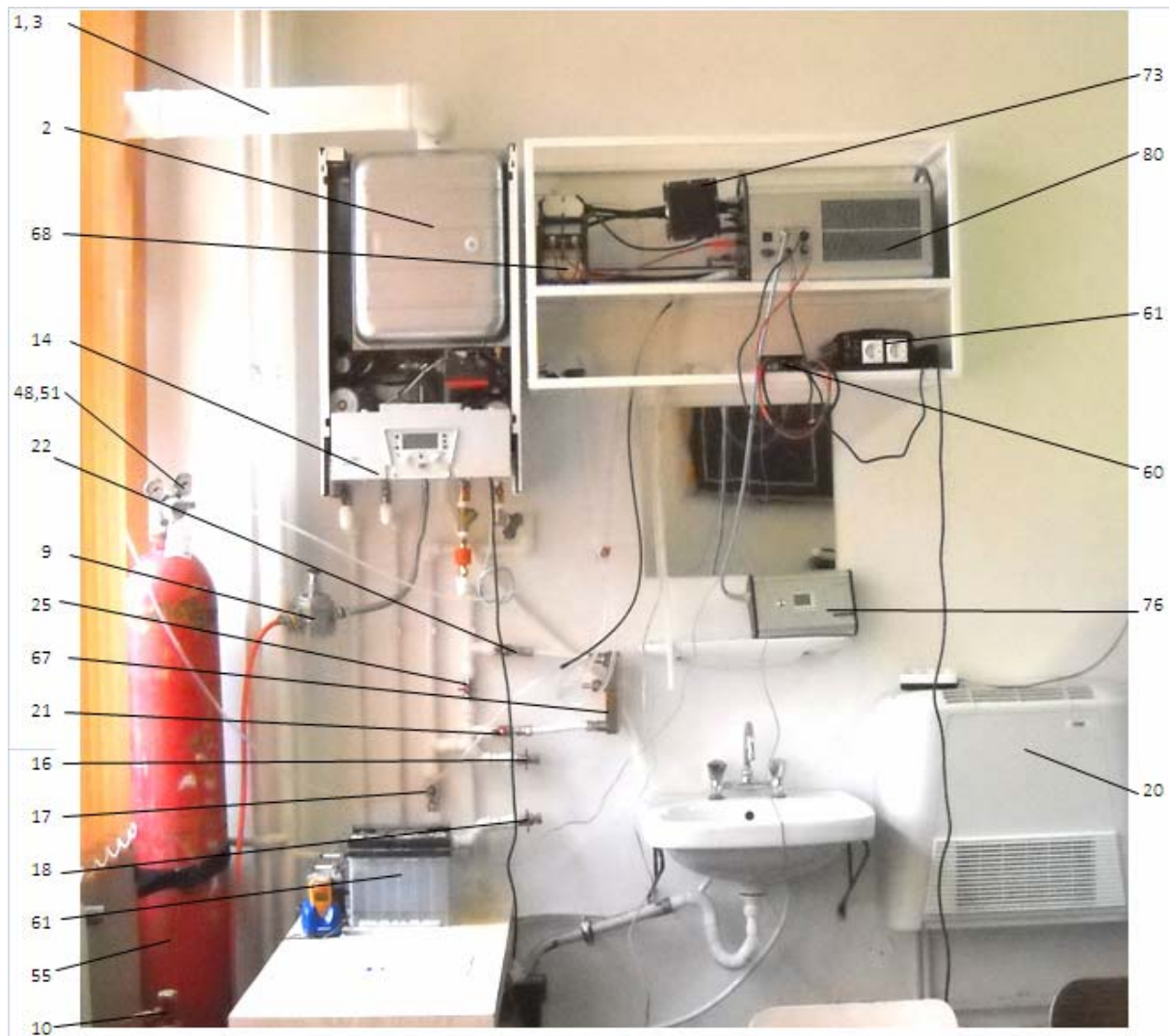
Figura 1. Imagine cu modelul experimental de microgenerare bazat pe pila de combustie tip PEM, FC-42 HCL 1
